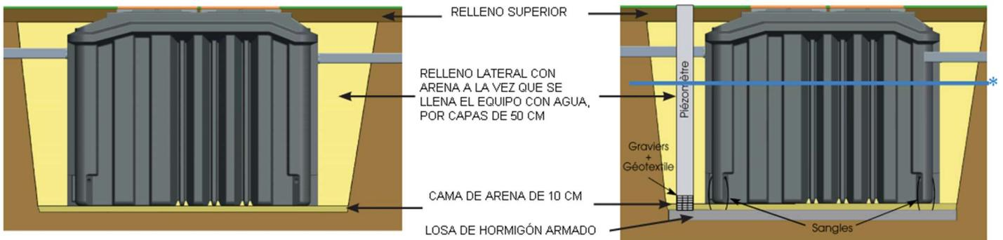
Esquema de principio de instalación Bioxymop 9 y 12 EH:
